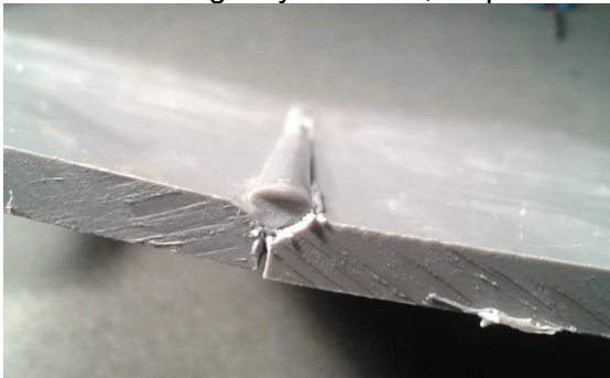
Zbyt niska temperatura zgrzewania
